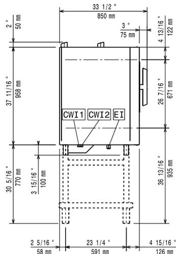
CWI1 = Kaltwasserzulauf                      EI = Elektroanschluss
